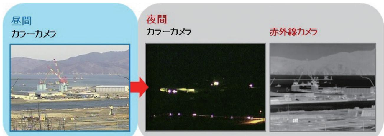
カラーカメラと熱検知型の赤外線カメラ
